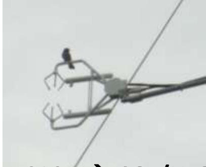
EC105 → CO 2 /H 2 O vapor CSAT3 → anemometer
